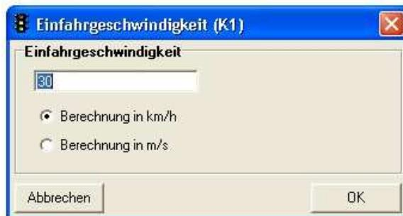
In der Kopfzeile steht die Gruppenbezeichnung der gewählten Gruppe. In dem Feld Einfahrgeschwindigkeit wird der aktuelle Wert für diese Gruppe vorgegeben. Für die Räumzeitenberechnung wird derjenige vorgegeben, der in den Stammdaten eingestellt wurde. Um die Einfahrgeschwindigkeit zu ändern, muss der vorgegebene Wert entsprechend verändert werden. Mit OK werden die Änderungen übernommen.
