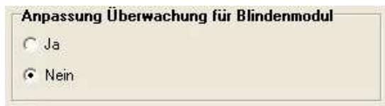
Werden Blindenmodule (Taktile Signalgeber / Vibrationstaster) angeschlossen, muss die Anpassung der Überwachung aktiviert werden.
