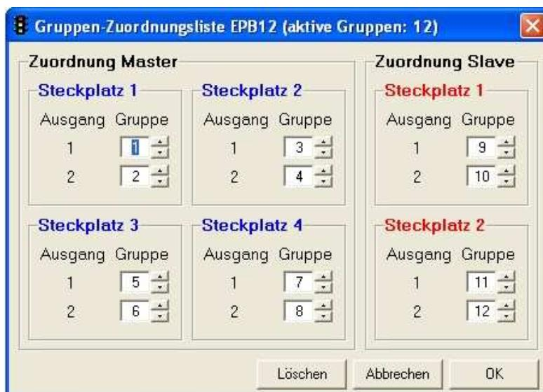
Wird nur das Mastergerät verwendet (8 Gruppen) braucht man die Standardzuordnung nicht zu verändern, da sich ja alle Signalgruppenanschlüsse in dem Gerät befinden.
