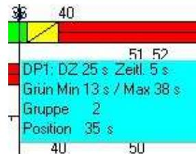
Sobald ein Dehnpunkt eingefügt wurde bzw. welche im Phasenplan vorhanden sind werden in der Überschrift des Phasenplaneditors die Mindest und Maximale Umlaufzeit angezeigt.
