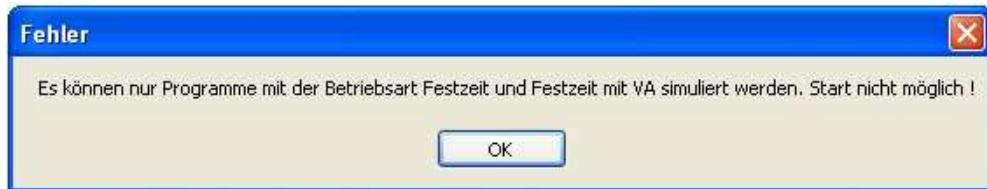
Da Programme der Betriebsart **VA - Betrieb** nicht simuliert werden können, muss nach Bestätigung der Fehlermeldung ein Programm der Betriebsart **Festzeit mit VA** geladen werden.
