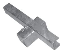
feuerverzinkt. Mit der Klemmhalterung ist die Montage von randverstärkten Tafeln in verschiedenen Höhen und auch ein seitliches Verschieben möglich. Die Spannschraube und ein Stift an der Halterung sichert das bis zu 40mm starke Schild gegen ungewolltes seitliches Verschieben.
