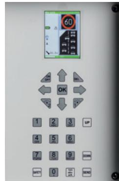
Bediengerät mit Farbdisplay direkt an der Vorwarntafel
