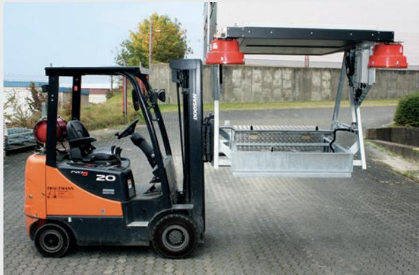
Einfach nur bei Bedarf mit dem Gabelstapler auf die Ladefläche des gewünschten Sicherungsfahrzeuges abgesetzt und über die Halteösen gesichert, schon kann die AV-LED praktisch mit jedem Pritschenfahrzeug zur Verkehrsabsicherung eingesetzt werden.
