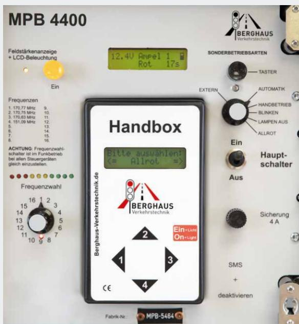
Einfache Handhabung durch menügeführte Handbox für bis zu 4 Signalgruppen. Bei Programmierung mit einem Laptop ist eine Regelung mit bis zu 12 Gruppen und maximal 24 überwachten und 24 Parallel-Signalgeber möglich.
