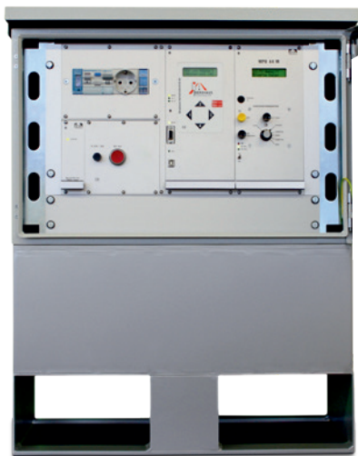
Das kompakte Master-Steuergerät MPB 44 M/S steuert bis zu 12 Signalgruppen an und versorgt zudem alle MPB 44 S-Ampelsignalgeber zentral mit Betriebsspannung in 42 Volt-Technik.
